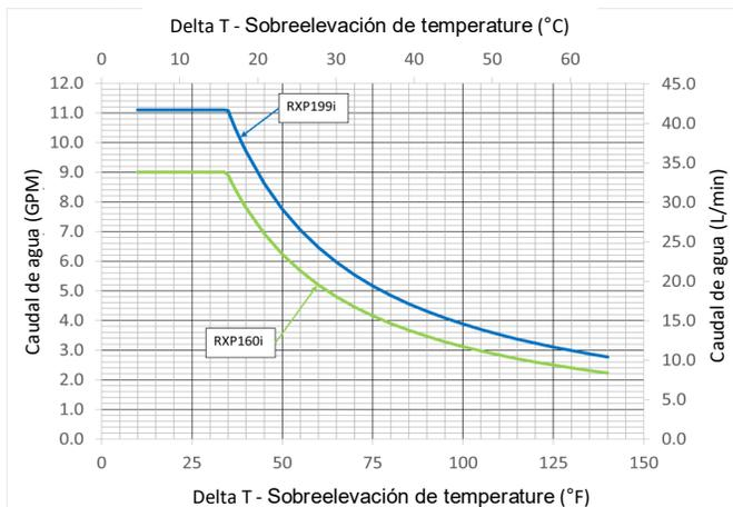
NOTA: Los caudales máximos pueden variar en función de la temperatura de ajuste, la sobreelevación de temperatura (Delta T) y la altitud.
